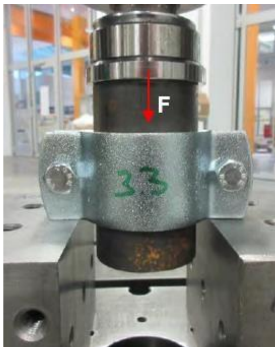
Пример использования одного хомута в осевом направлении (вариант 1):
