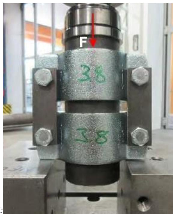
Пример использования пары хомутов в осевом направлении (вариант 2):
